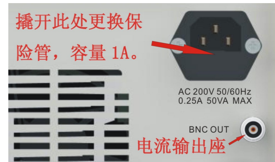
图 4-7 220V 电源输入插座和 BNC 输出座
